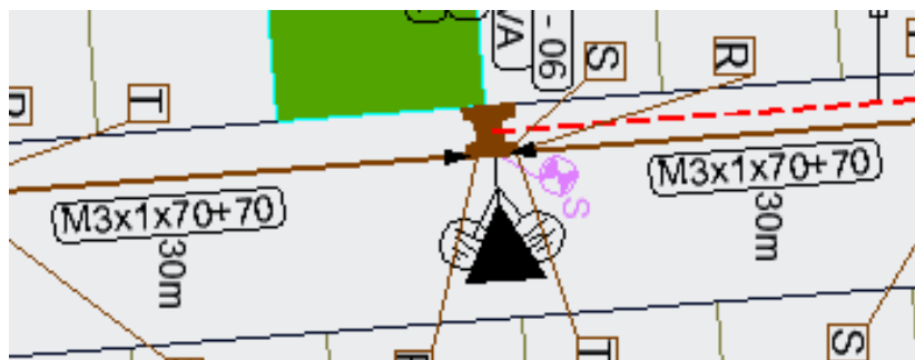
Figura 12: Detalhe do Condutor - tronco para SBE de 75 kVA. [Fonte: Da Autora]
