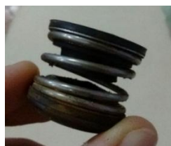
FIGURA 16 – SELO MECÂNICO DEFEITUOSO.
