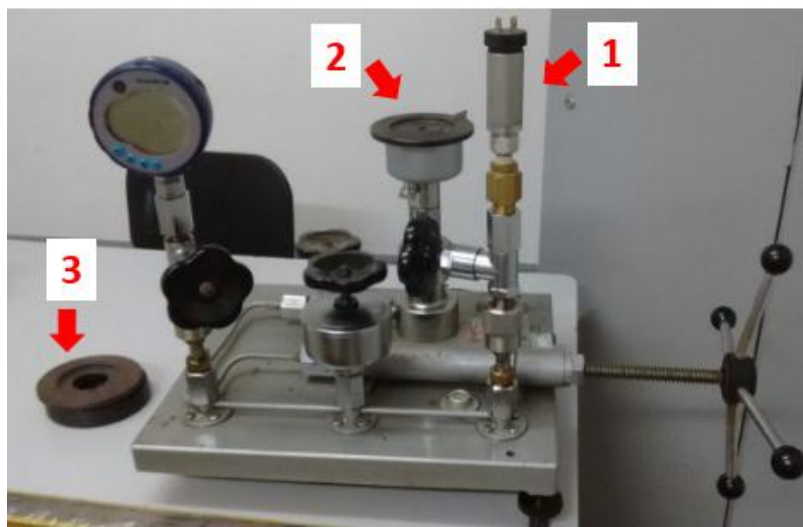
FIGURA 22 – BALANÇA DE PESO MORTO USADO PARA CALIBRAÇÃO.
