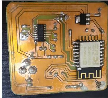
Figura 12: Circuito montado com o novo *layout* projetado pelo autor também.
