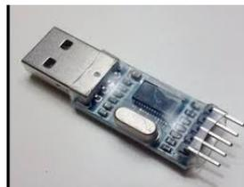
Figura 9: Conversor USB para TTL
