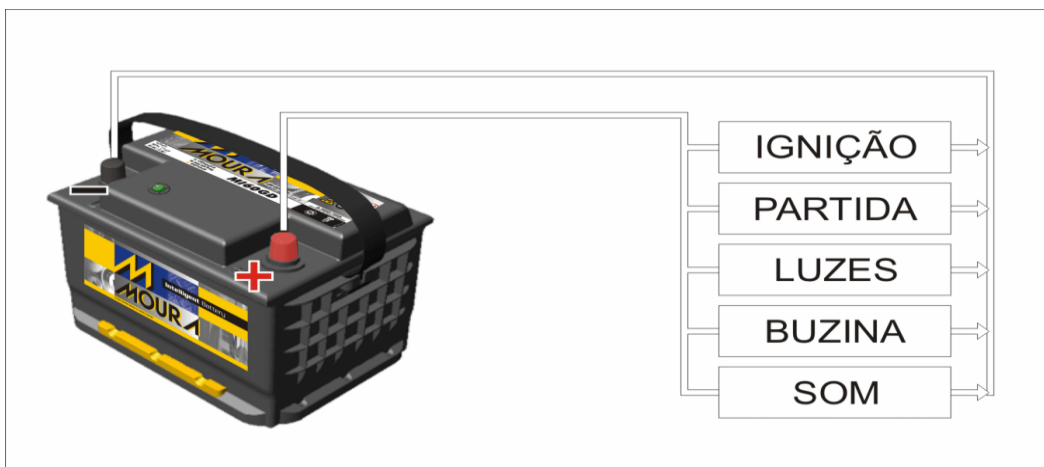
Figura 5. Esquema funcional da bateria. (CABRAL, 2013, p.4).
