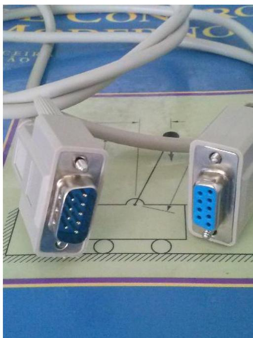
Figura 2 – Cabo serial para conectar a IHM ao CLP
