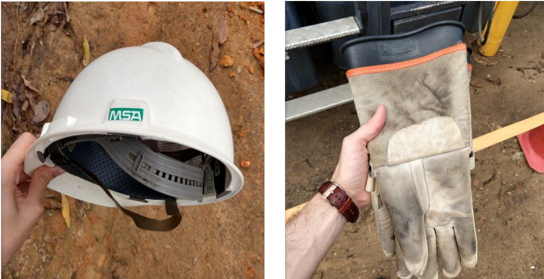
Figura 3: Verificação da ausência de falhas em EPIs
