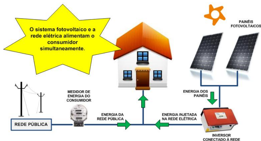
Figura 2-Sistema Fotovoltaico Conectado à Rede
