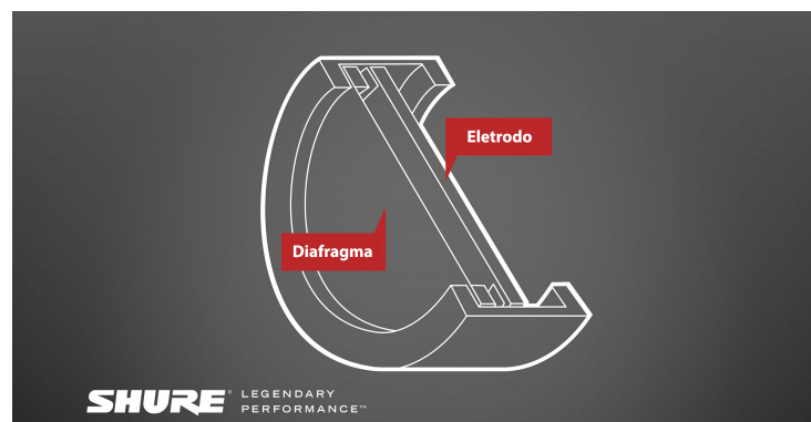
Figura 11 – Estrutura de um microfone condensador
