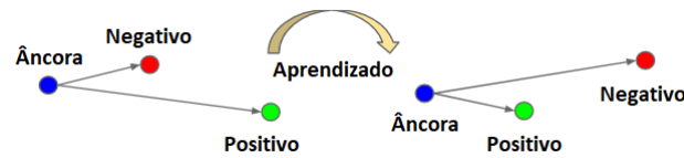
Figura 49 – Etapa de treinamento da RNCP baseado em triplets
