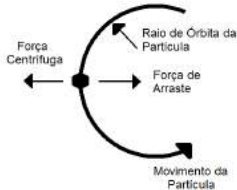
Figura 2: Forças agindo em uma partícula orbitando o hidrociclone.
