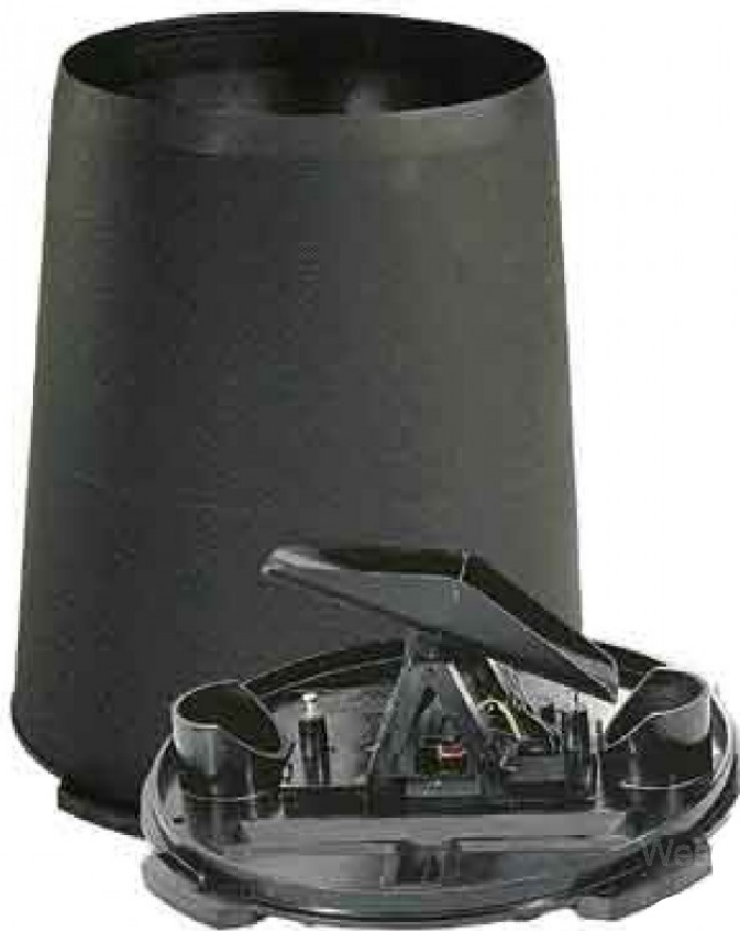
Figura 10: Pluvimetro do tipo bscula.
