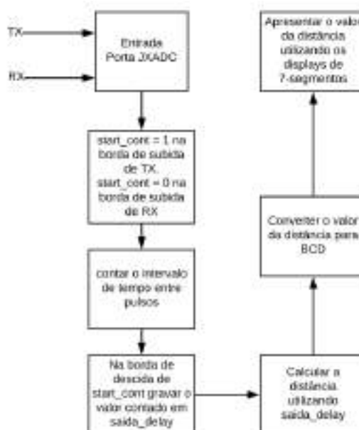
Figura 29 - Processo de funcionamento do programa medidor de distância.
