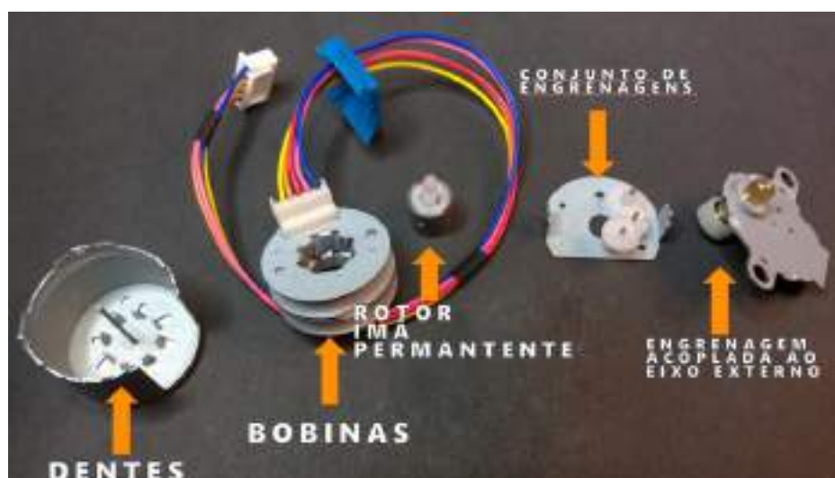
Figura 24 - Componentes do motor de passo 28BYJ - 48.
