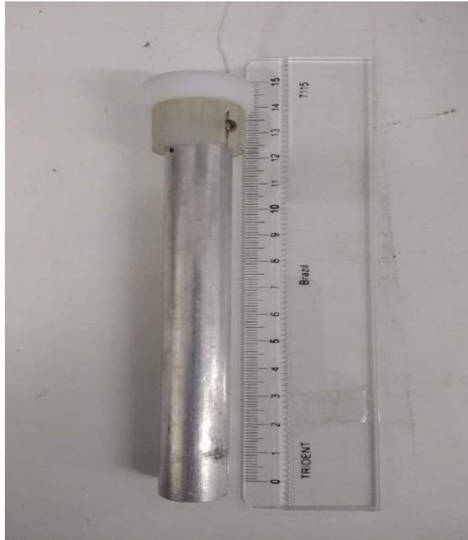
Figura 18 - Sensor de nível capacitivo construído
