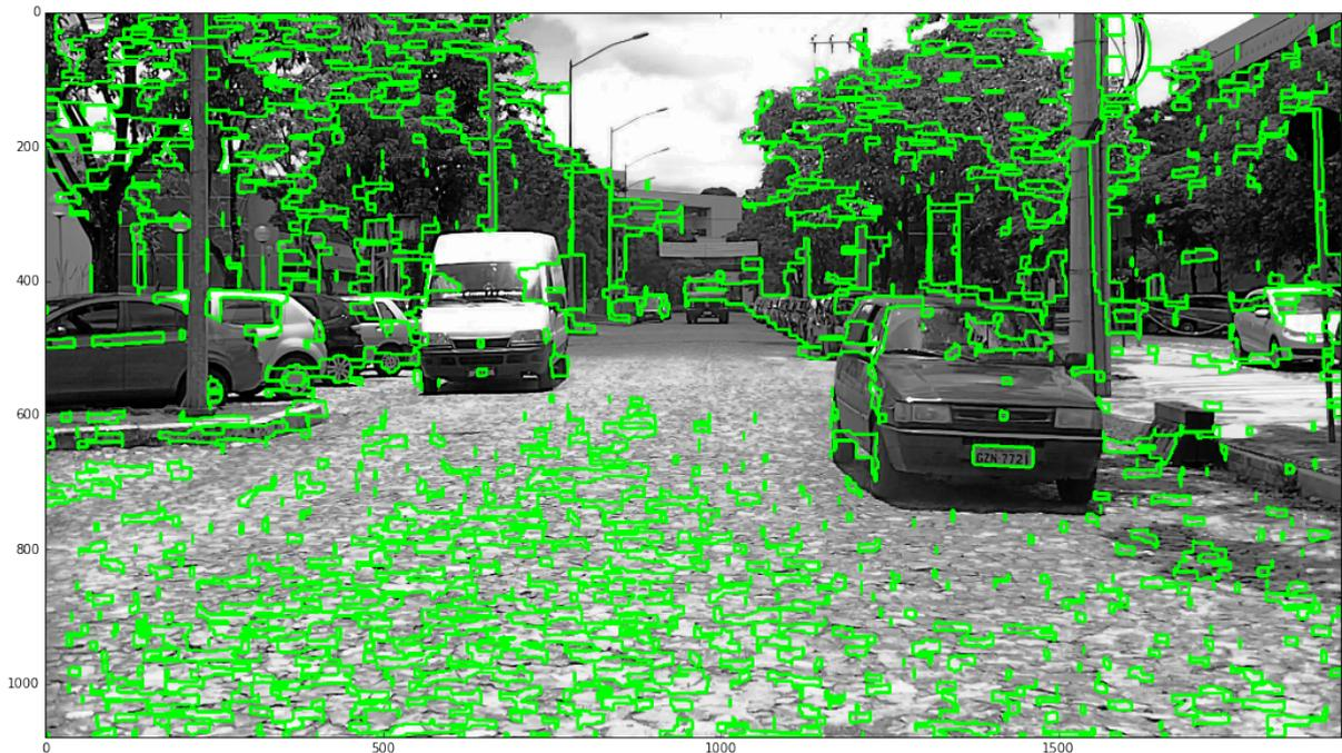
sugerido pelo OpenCV para trabalhar com Transformada de Hough que utiliza o detector de bordas Canny para gerar a imagem de gradiente a ser utilizada pela TH. De modo similar, acrescentou-se um detector de bordas ao final da etapa de segmentação de ambas as abordagens para gerar uma imagem de gradiente otimizando a TH. O detector de bordas utilizados para essa abordagem foi a operação morfológica denominada Gradiente Morfológico.
