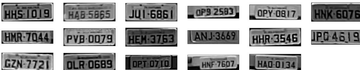
A primeira etapa desse algoritmo consistia na limiarização das placas, para isso foi utilizado o limiar obtido pelo método de Otsu. Entretanto, devido a irregularidade na iluminação das placas o método de Otsu falhou na limiarização de uma das placas acima, como pode ser visto na Figura 33 em que a placa falha aparece com o destaque vermelho.
