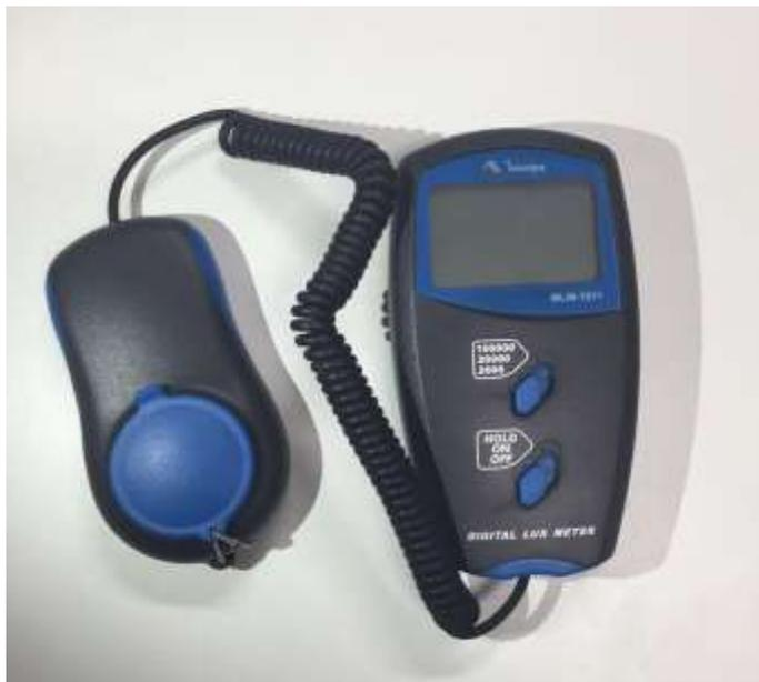
Figura 4.1 - Luxímetro utilizado para as medições
