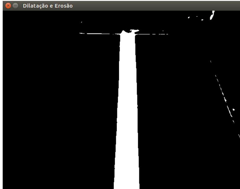
Figura 17. Imagem após o uso dos processos de dilatação e erosão.
