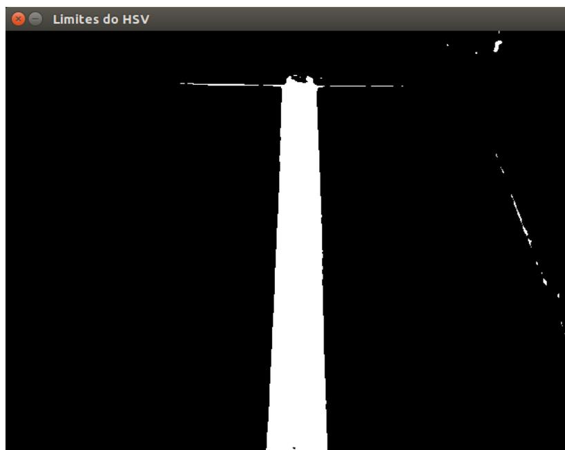
Figura 16. Imagem binarizada baseada nos parâmetros da calibração.
