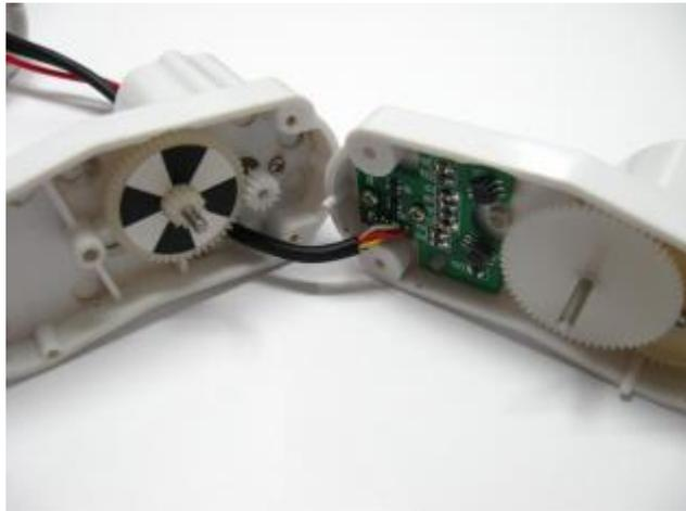
Figura 7. *Encoder* acoplado ao chassi do robô.
