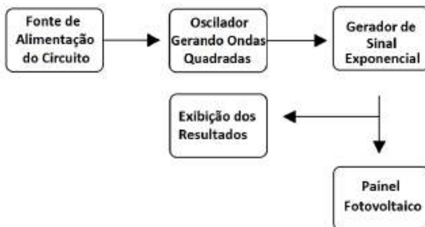
Figura 14 – Sequência de eventos para caracterização de painéis fotovoltaicos.
