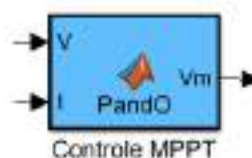
Figura 29: Bloco de Modelamento do Controle MPPT com Técnica P&O
