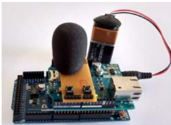
Figura 9 – Sistema de Aquisição de Áudio e Cálculo da FFT
