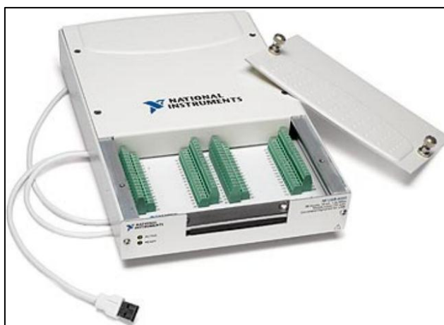
Figura 3.10 – Placa de aquisição de dados NI USB 6229
