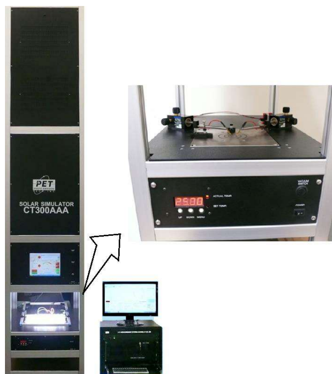
Figura 52. Simulador Solar CT300AAA-TP com detalhe do traçador de curva I-V Fonte: Adaptado de PET (2015)
