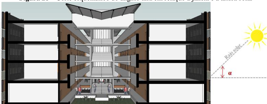
Figura 28 – Corte esquemático do ângulo alfa em relação à janela e à altura solar
