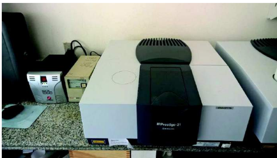
Figura 49. Espectrofotômetro de infravermelho da Shimadzu, modelo Prestige-21.
