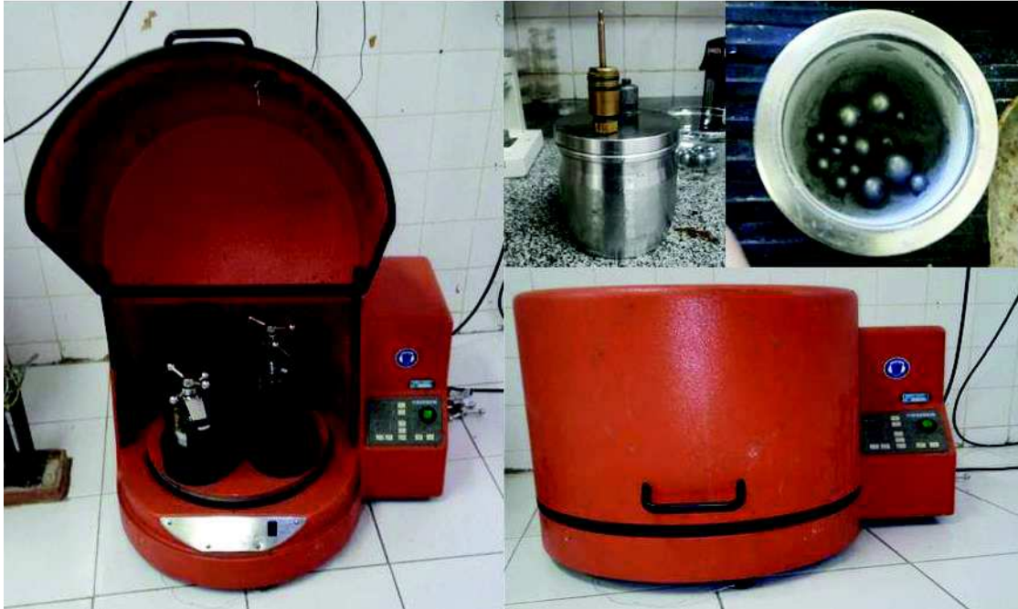
Figura 41. Moinho Planetário de alta energia do tipo Fritsch Pulverisette 5 e as jarras utilizadas para a moagem.
