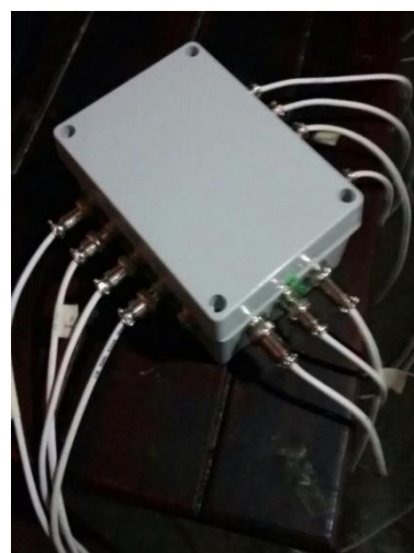
(c)Gabinete sensores conectados
