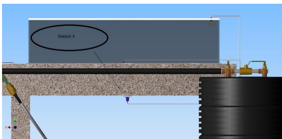
Figura 30 – Detalhe localização do sensor 4, no isolamento térmico.
