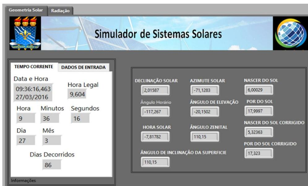
Figura 50 – Tela 1 do simulador de sistemas solares
