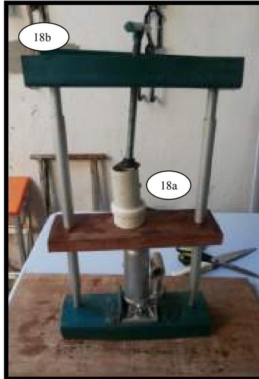
**Figura 18** – a) Forma de PVC; b) Prensa
